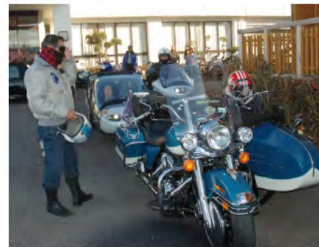
四国でのハーレーサイドカーはけっこうめずらしい存在である。左カーということは純正でなく、後付けのカーということになる
