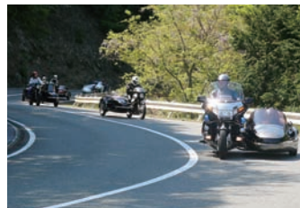
コーナーリングも左カーと右カーでは操作が逆になるのがサイドカーの特性
